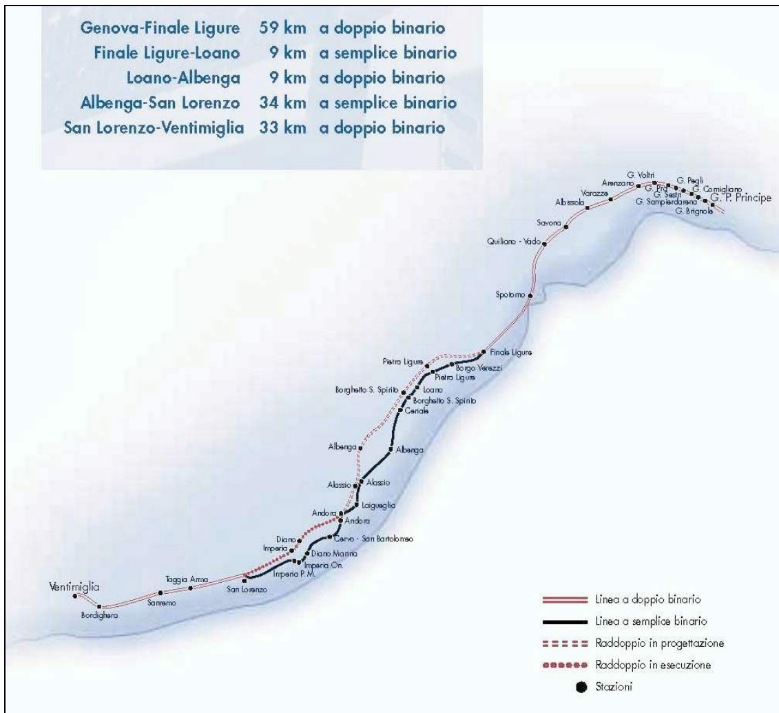
Planche 1 La ligne littorale ligure – Situation actuelle (Tableau) et tracés de réalignement et doublement en cours ou en projet (carte)
